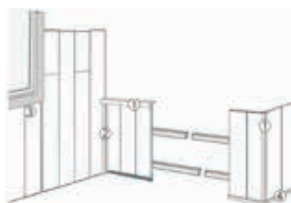
Joint de dilatation : 10 mm
