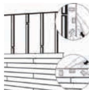
Poursuivez la pose en partant d'en bas avec la chute de lame en l'engageant dans la lame précédente. Renouvelez l'opération jusqu'à l'avant dernière lame.
