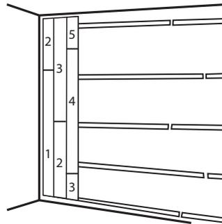
Assurez un emboîtement parfait à l'aide d'un bout de chute et du marteau puis fixez la lame dans les tasseaux. Tous les trois ou quatre rangs, contrôlez l'aplomb à l'aide du niveau à bulle.
