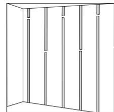
Il est conseillé de commencer par le bas en plaçant la partie à fixer vers le haut selon les indications de la fiche technique en tenant compte du joint de dilatation de 10mm. Vérifiez le niveau puis fixez la première lame sur les tasseaux en la traversant de part en part sur la partie basse puis fixez la partie haute selon les indications de la fiche technique. Mesurez la distance restante jusqu'au mur et coupez la lame en fonction (en retranchant 10 mm pour l'espace de dilatation).
