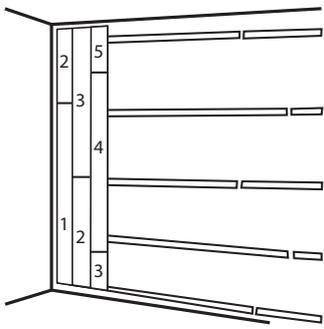
Mesurez la distance restante jusqu'au plafond et coupez la lame en fonction (en retranchant 10 mm pour l'espace de dilatation). Attention, lors de la coupe, contrôlez bien le sens d'assemblage de la rainure. Poursuivez la pose en partant du bas avec la chute de lame en l'engageant dans la lame précédente.
