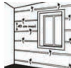
Fixez les tasseaux au mur à l'aide de chevilles adaptées au support en contrôlant le niveau régulièrement. Rectifiez les éventuels défauts du mur afin d'avoir un support plan (Cales en bois ou PVC).
