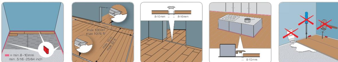
Le sol stratifié BerryAlloc doit être installé en pose flottante, ce qui signifie que le parquet doit pouvoir bouger librement :
