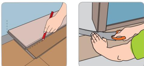
Pour installer la dernière rangée, positionnez une lame exactement au-dessus de la rangée précédente. Placez une autre lame à l'envers contre le mur et tracez une marque sur le dessous de la lame. Coupez la lame marquée pour déterminer la bonne dimension et la mettre correctement en place.
