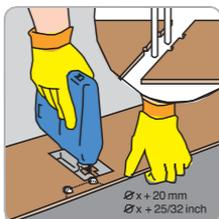
Si vous avez des tuyaux de chauffage, mesurez leur position exacte et tracez une marque sur le sol stratifié. Ajoutez 20mm à la dimension du tuyau, car le sol stratifié doit être en mesure de bouger librement dans tous les sens autour du tuyau. Sciez à partir des trous de forage jusqu'au côté du sol stratifié à un angle de 45 ° et mettez le sol stratifié en place.
