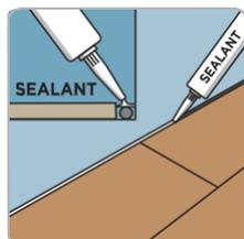
**ÉTAPE 2 :** Comblez l'écart de dilatation avec le **Mastic Hydro Plus**. Le mastic doit toucher le mur et le sol stratifié de telle manière que lorsqu'il est appliqué, il comble complètement le joint.
