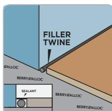
**ÉTAPE 1 :** Utilisez le **Fillertwine BerryAlloc** sur le joint de dilatation. La pâte de garnissage fillertwine permet au sol stratifié de se dilater/rétracter. À utiliser également sur l'écart de dilatation sous les profils de sol comme les barres de jonction, les barres de seuil...
