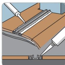
Avec les profils de sol, utilisez une pâte de garnissage par-dessus le fillertwine avant d'installer le profil, afin d'éviter au côté et à la base du sol stratifié tout contact avec l'eau
