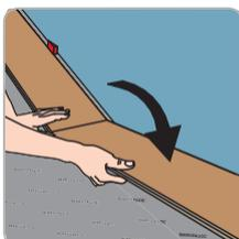
Pour un aspect de bois plus naturel, veillez à mélanger les motifs des lames sur tout le sol. Les joints d'extrémité doivent être décalés de 30 cm min. lors de l'installation des lames de parquet.
