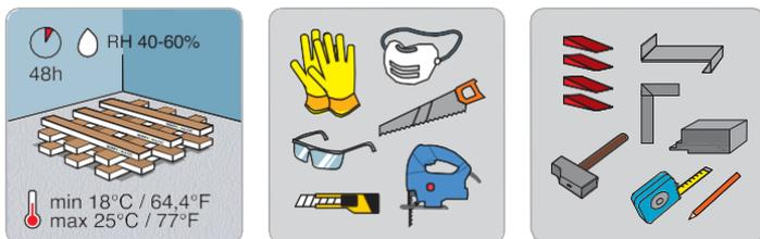
Il est important de stocker vos boîtes de stratifié à température ambiante au moins 48 heures avant l'installation. Ne pas ouvrir les boîtes, les empiler de manière à avoir un contact maximal avec l'air. Le sol doit être installé à une température ambiante de 18 à 25 ° C et un taux d'hygrométrie de 40 à 60%.
