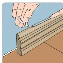
**ÉTAPE 3 :** Appliquez une **Bande de Protection HydroPlus** à la base de la plinthe à l'aide d'une bande adhésive. Cette bande protège votre plinthe de l'humidité, tout en permettant au sol stratifié de se dilater/rétracter.
