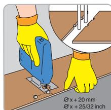
Si vous avez des tuyaux de chauffage, mesurez leur position exacte et tracez une marque sur le sol stratifié. Ajoutez 20mm à la dimension du tuyau, car le sol stratifié doit être en mesure de bouger librement autour du tuyau. Sciez à partir des trous de forage jusqu'au côté du sol stratifié à un angle de 45 ° et mettez le sol stratifié en place.
