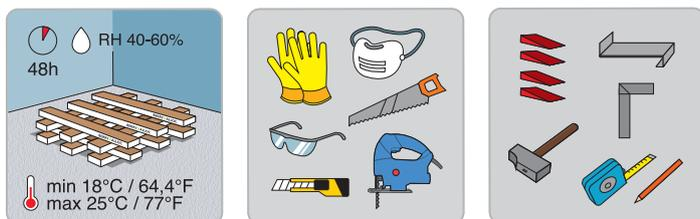
Il est important de stocker vos boîtes de stratifié à température ambiante au moins 48 heures avant l'installation. Ne pas ouvrir les boîtes, les empilez de manière à avoir un contact maximal avec l'air. Le sol doit être installé à une température ambiante de 18 à 25 ° C et un taux d'hygrométrie de 40 à 60%.
