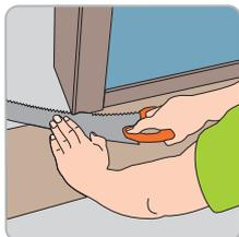
Les encadrements de porte doivent être suffisamment raccourcis pour incorporer en-dessous une lame et une sous-couche. Posez une lame face vers le bas, à côté de l'encadrement de porte. Sciez la lame puis faites-la glisser sous l'encadrement de porte. Conservez un espace de dilatation de 8-10mm sous l'encadrement de porte !
