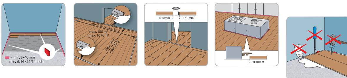
Le sol stratifié BerryAlloc doit être installé en pose flottante, ce qui signifie que le parquet doit pouvoir bouger librement :
