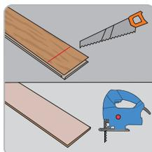
Si vous utilisez une scie manuelle, coupez la lame face décor. Si vous utilisez une scie sauteuse électrique, coupez toujours le dos de la lame. Pour des résultats optimaux, l'utilisation d'une lame de scie affûtée est un must !
