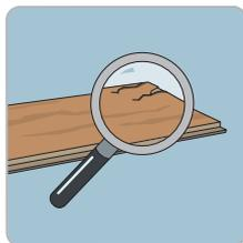
Vérifiez que toutes les lames ne comportent aucun défaut visible sous des conditions optimales de lumière, avant et pendant l'installation. Vous ne devez pas utiliser de lames défectueuses.
